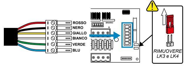
Montare il connettore verde con i fili colorati nell'ordine mostrato sopra. Collegare il connettore nella presa corretta e stringere il passacavo per fissare il cavo.
